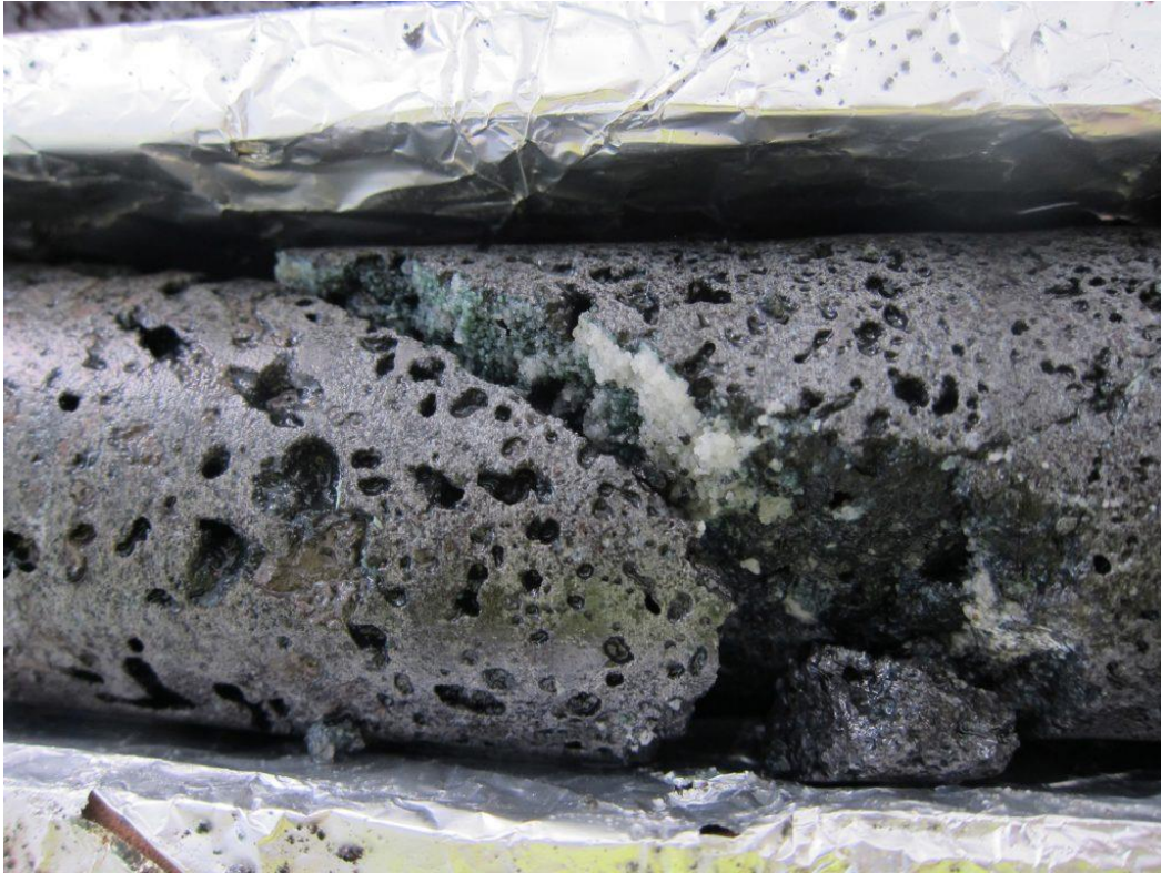
MYND 2.2 Steinrunnið CO 2 , í formi karbónat steinda (hvítir flekkir), eftir niðurdælingu á vegum Carbfix.
